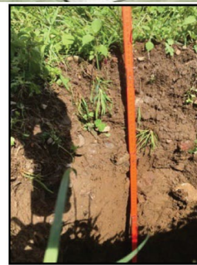
Bodenprofil 3 Verdichtung in 20-40 cm
