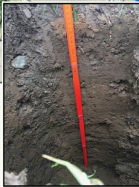
Bodenprofil 1 Verdichtet in 20-40 cm
